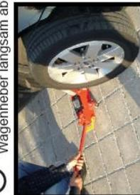
Unterstellbock entfernen, Wagenheber langsam ablassen.
